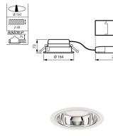
Scheda tecnica Philips Downlight LED LuxSpace Mini DN560B VLC-E 7W 840lm 80D - 830 Luce Calda | 164mm - Aluminium Riflettore - Dali Dimmerabile
